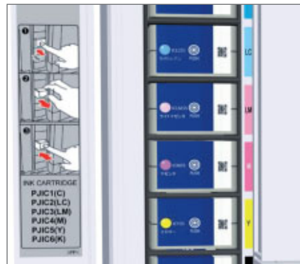
Separate Tintenpatronen für alle sechs Farben lassen sich in wenigen Sekunden bequem und einzeln austauschen.
